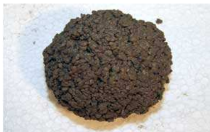
„boule de neige“ avec consistance terre-humide optimale
