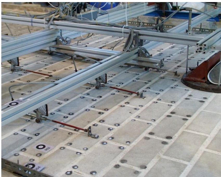
Abb. 6: Induktive Wegaufnehmer mit Meßpunkten und Pendelstäben
