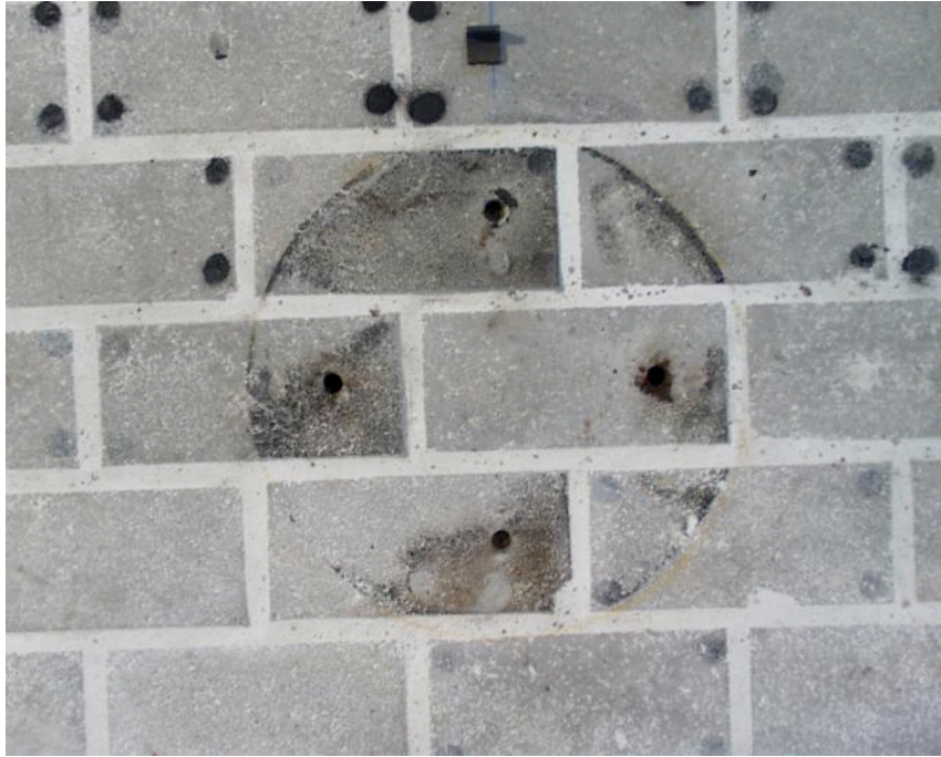
Abb. 8: Bereich der Lastplatte nach 2,5 Mio Lastwechseln
