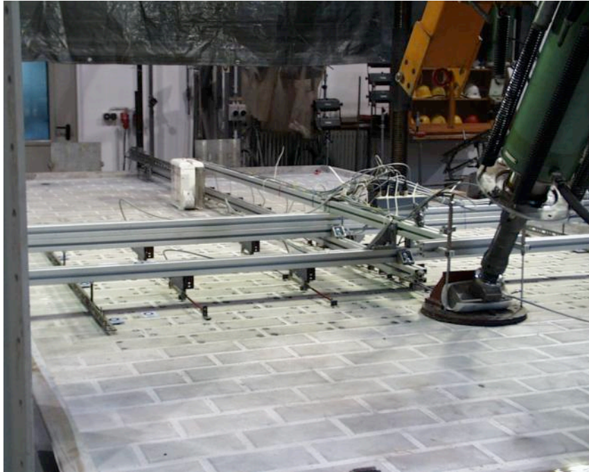
Abb. 5: Belastungszylinder und Wegaufnehmer im Meßgerüst
