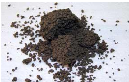
Zerfallener „Schneeball“ bei zu trockener Konsistenz
