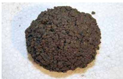
„Schneeball“ bei optimaler erdfeuchter Konsistenz
